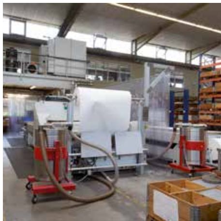
Nádoba predbežného oddeľovača (200 litrov) so sklápacou hlavňou
