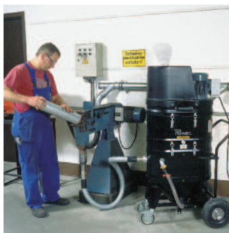
NA 35 typ WSP w obróbce aluminium
